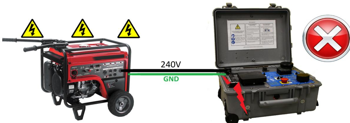
Le fil électrique vert n'est donc pas connecté et l'utilisateur doit mettre à terre à la fois le transmetteur et la génératrice. Si l'on omet de le faire, il est quand même plus sécuritaire d'opérer le transmetteur que si le fil électrique vert était connecté puisque que le châssis du transmetteur est isolé électriquement de la valise en plastique et du châssis métallique de la génératrice.
