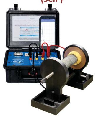
Obtenez les informations nécessaires pour élaborer des levés géophysiques appropriés! Le testeur SCIP est un instrument novateur pour mesurer et enregistrer les propriétés électriques des carottes de forage, des échantillons rocheux ou de sols et des affleurements. Affiche les données en temps réel. Permet de corréler les carottes de forage aux levés de résistivité et de polarisation provoquée. Aide à mieux définir vos inversions géophysiques.
