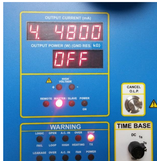
4 Tx en la cadena Multi-Tx con tensión de salida nominal total de 4800V
