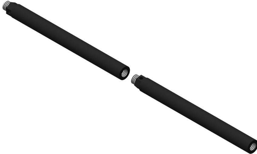
La varilla une los dos soportes. Uno de ellos es móvil y se desplaza a lo largo de la varilla permitiendo ajustar la distancia entre los soportes en función del largo del núcleo. Es posible fijar dos o tres varillas juntas para aumentar la distancia entre los dos soportes. Para fijar la varilla, insertarla y luego atornillarla. Desatornillar la varilla para retirarla del soporte. Si lo encuentra difícil, utilizar una llave para tuerca de 5/8" o la llave Allen.
