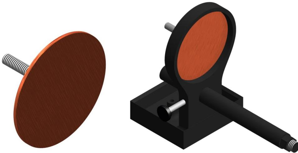
Los electrodos son constituidos de un disco de cobre fijado a un perno de acero inoxidable. Un conector banana puede ser directamente enchufado al perno para obtener un mejor contacto. Es posible ajustar la distancia entre el electrodo y el soporte atornillando o desatornillando el electrodo con la ayuda de la llave Allen.
