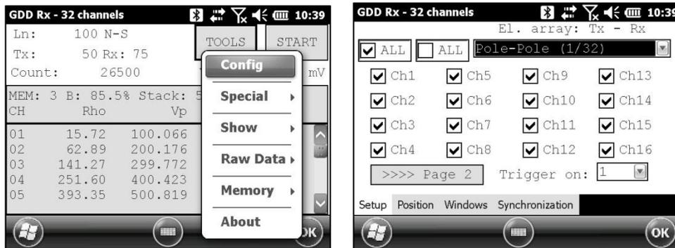
2. Seleccionar la disposición de los electrodos.
