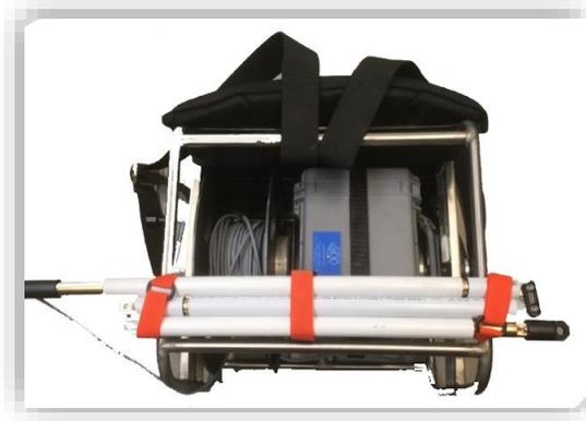
La sonda SCIP Borehole es muy útil para levantamientos detallados de PI en agujeros de perforación. La sonda se puede usar en la configuración Dipolo-Dipolo o Wenner de acuerdo con las conexiones de los electrodos.
