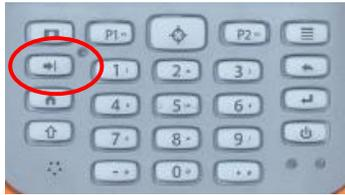
Para un núcleo de perforación (cilíndrico), seleccionar *Diameter* y luego entrar el valor del diámetro en mm. Si el núcleo es cortado en dos sobre lo largo entonces seleccionar *Half Sample*.
