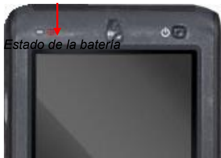
Estado de la batería
