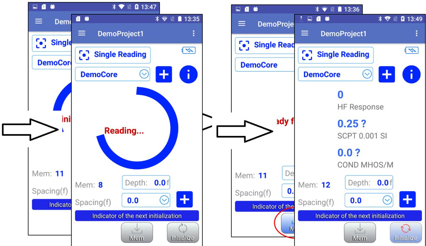
Esta lectura está asociada al núcleo seleccionado y llevada a la posición de profundidad actual. Si el espaciado actual no es 0, la profundidad actual se incrementa por el valor del espaciado y la siguiente lectura se almacenará en esta posición de profundidad.
