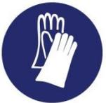
Se recomienda el uso de guantes de seguridad aislados eléctricamente de clase 1 (7,5kV).
