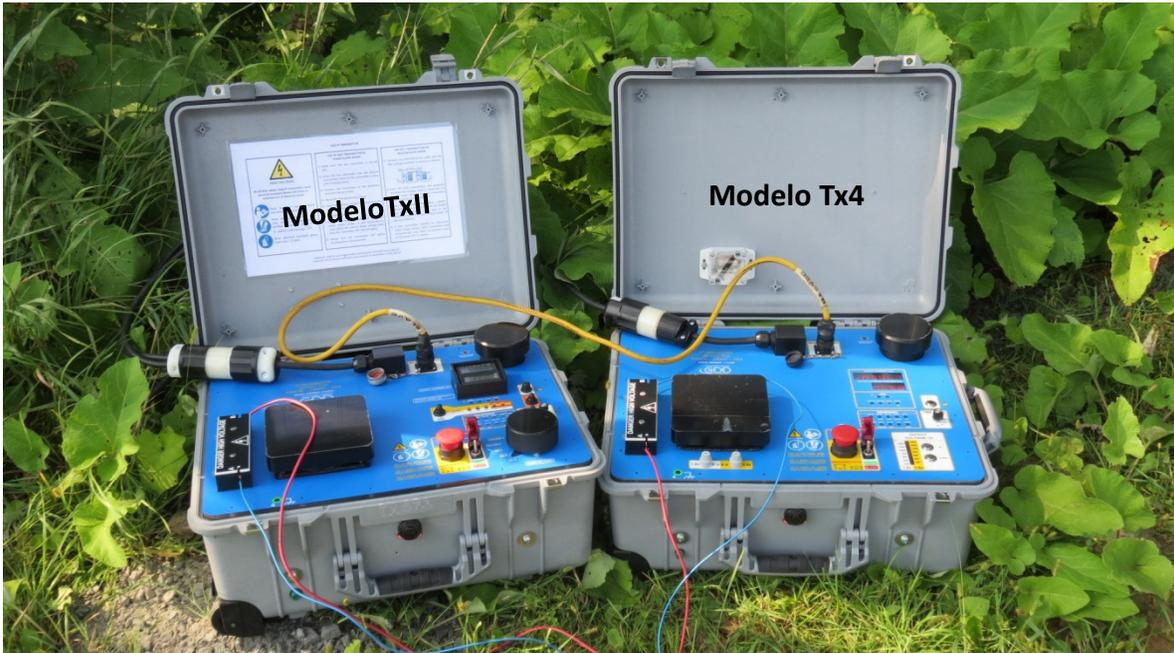
**Modelo Tx4 en modo *Master/Slave* proporciona hasta 10,000W-4800V-20A (2x).
