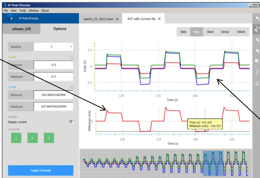
Tensión primaria "Vp" medida en el **Receptor PI** (datos de onda completa (*fullwave*) disponibles cuando utilizando los Receptores PI de GDD)
