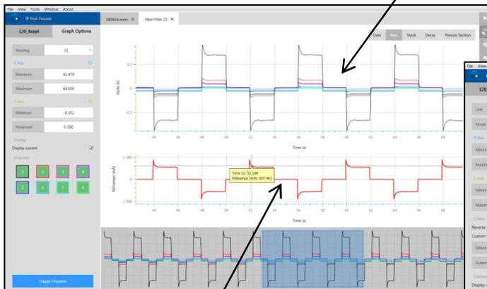
Visualizar la onda completa de la corriente "I" medida cada 1ms utilizando el nuevo Controlador PI-EM-Tx
