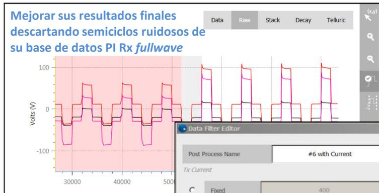
Visualizar en detalle la onda completa de tensión primaria "Vp" medida en el Rx PI
